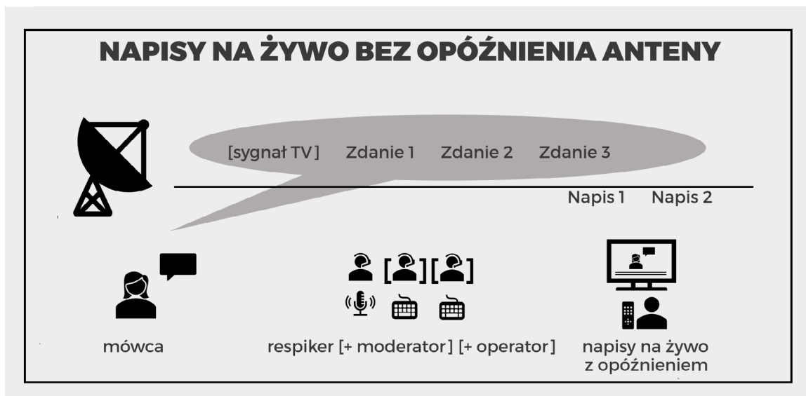
Rysunek 3. Schemat procesu powstawania napisów na żywo bez opóźnienia sygnału telewizyjnego
